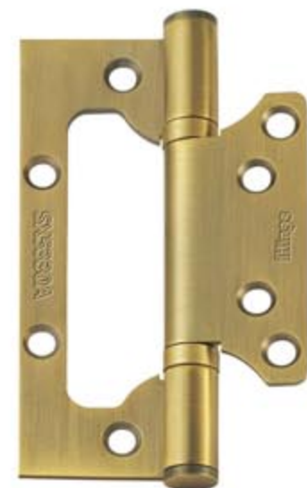
5寸轴承铁子母合页(偏轴) 型号(Model): P子母5330A(哑光黄古铜) 参数(Parameter): 5x3x3.0mm 125mmx79mmx3.0mmxΦ14.0mm
