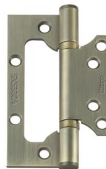
5寸轴承铁子母合页(偏轴) 型号(Model): P子母5330A(哑光青古铜) 参数(Parameter): 5x3x3.0mm 125mmx79mmx3.0mmxΦ14.0mm
